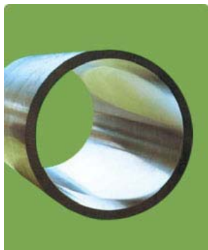
Tubi s.s. in acciaio St 52 trafilati a freddo levigati o rullati internamente in toll. H8 EN 10305-1 E355+SR
